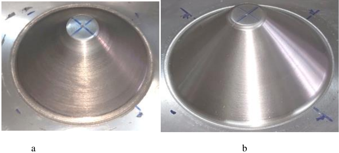
Hình 5. 15 Sản phẩm bôi trơn bằng than chì (a) và sản phẩm bôi bằng dầu bôi trơn (b).
