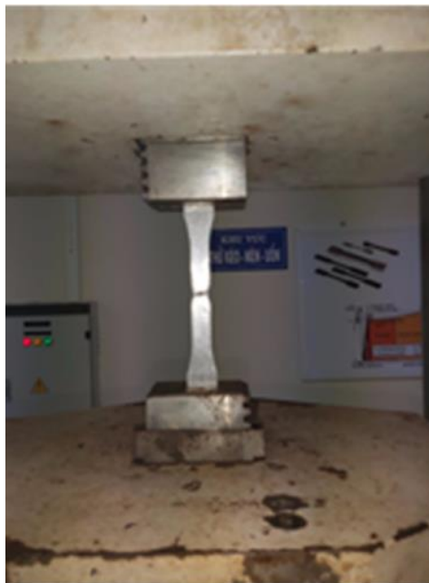
Hình 5. 4 Mẫu sau khi kéo đứt
