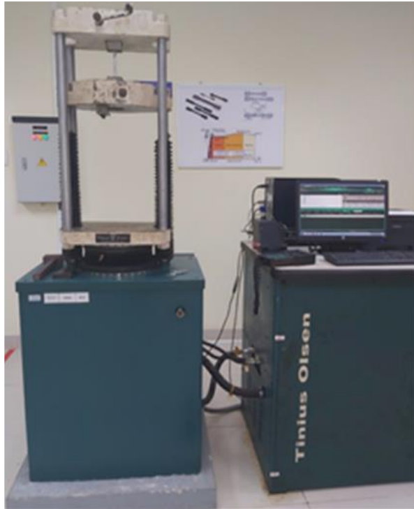
Hình 5. 3 Thử mẫu kéo tại phòng thí nghiệm Cơ-Lý trường Đại học Dầu Khí Việt Nam
