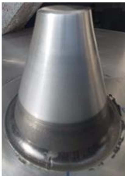
Hình 5.12 Sản phẩm tạo hình bằng công nghệ TPIF được tích hợp 4 loại chất bột trơn trên cùng sản phẩm côn nón góc nghiêng 70^\circ
