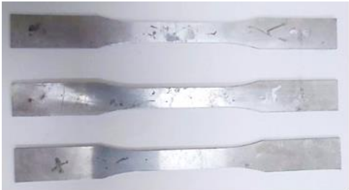
Hình 5. 1 Kích thước mẫu theo tiêu chuẩn [46] hoặc ISO 6361-2:2014
