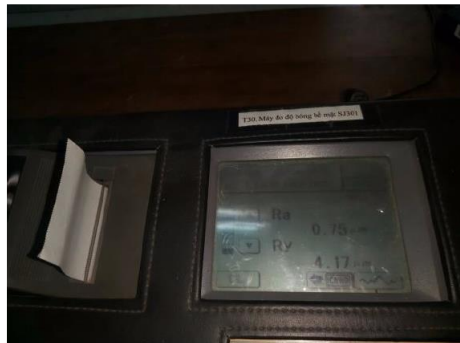
Hình 3. 20 Máy đo độ nhám Mitutoyo SJ 301
